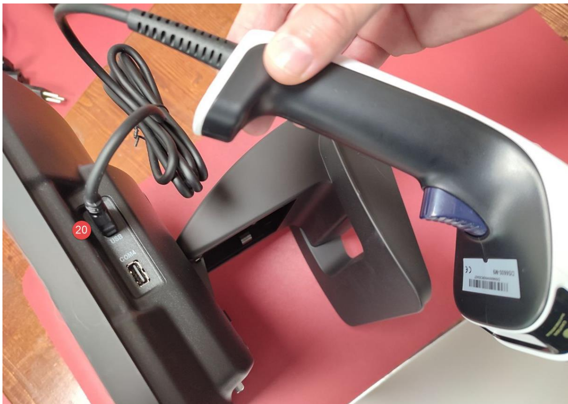
(20) Porta USB per attaccare lo scanner barcode > sul lato destro del registratore di cassa ATTENZIONE > non attaccare sulla porta COM
